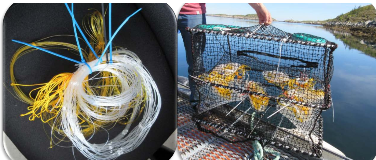
Figur 4: Samplene av nedbrytbare- (hvitt) og nylon monofilament (gul) (og netting) ble satt i sjøen i Trondheim (tre teiner) og i Tromsø (to teiner).
